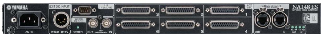
ネットワークオーディオインターフェース NAI48-ES は、通信プロトコルに EtherSound™ を採用したデジタルオーディオ用インターフェースです。PM5D や M7CL、LS9 といったオールインワンタイプのデジタルコンソールから、NAI48-ES を経由して AD8HR や DA824 を接続することで、離れたステージ上のステージボックス設置を可能にします。従来のアナログコンソール + アナログマルチケーブルのセッティングに比べてノイズの影響も受け難く、さらにマイクケーブル配線の最短路による音質の向上やシンプルで手軽なセッティングなど、ステージボックスを構築する際のパフォーマンスを高めてくれます。
